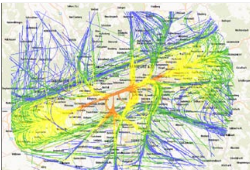
Graphik 1: Anflüge und Abflüge am Flughafen Frankfurt am Main am 22.08.2005 bei Betriebsrichtung Ost und West (Quelle: Beecken 2005)
