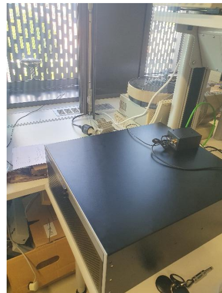
Abbildung 9: Ein baugleicher Rechner des Forschungszuges, darauf das GNSS-System und Antenne zum Test der Datenschnittstellen des Gesamtsystems im Labor der TUC
