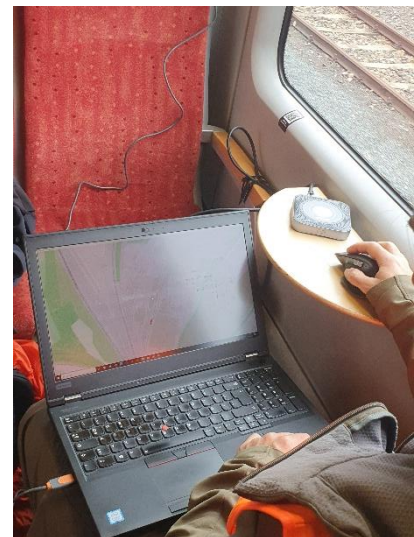
Abbildung 5: Testsetup zur Steuerung, Überwachung und Aufzeichnung des GNSS-Systems zur temporären Installation
