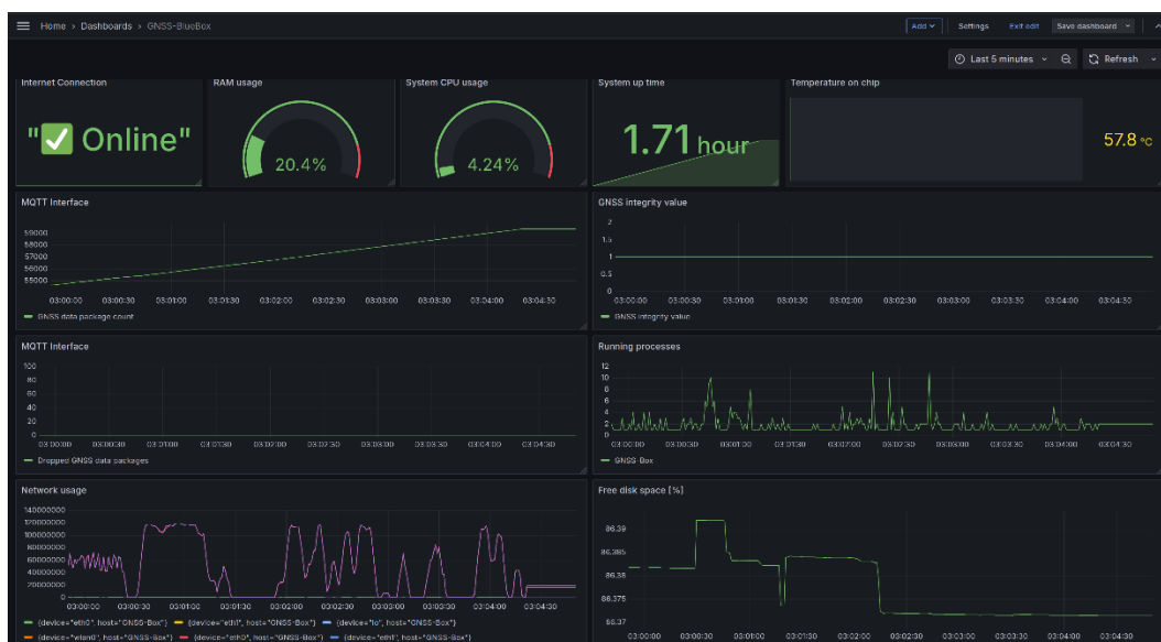
Abbildung 6: Screenshot des GNSS-System Monitorings; Überwacht werden Hardwareparameter wie Auslastung und Temperatur sowie die Schnittstellen und Datenaustausch auf Softwareebene
