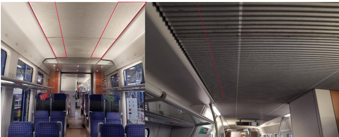
Abbildung 1: Anbringung der Lautsprecherbahnen unter- bzw. oberhalb des Deckenpanels
