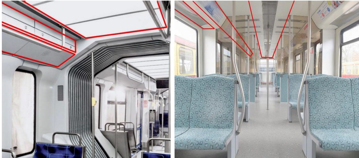
Abbildung 2: Anbringungsmöglichkeiten in den Vouten und der Mitteldecke
