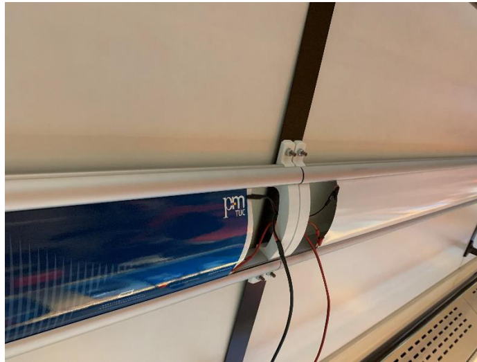
Abbildung 17: Verdrahtung von zwei Lautsprechermodulen
