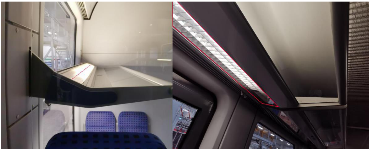
Abbildung 4: Anbringung in der Gepäckablage als Lichtabdeckung (transluzent)
