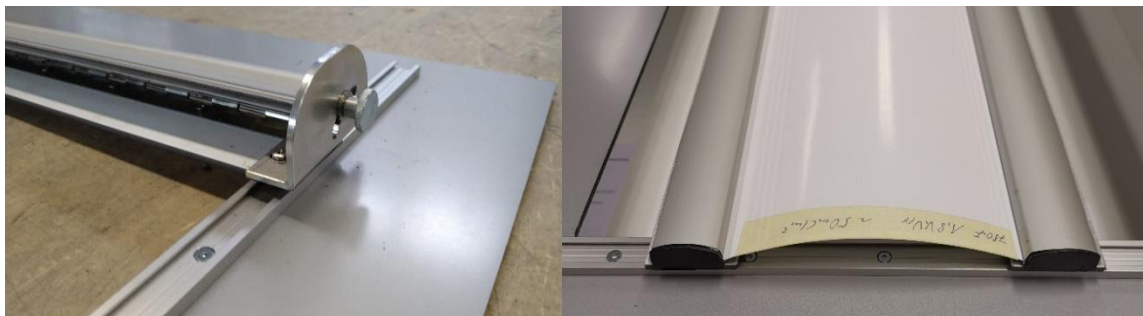
Abbildung 9: Verstellbare Befestigung Rollenbahn (links) / Eingespannte Lautsprecherbahn mit Wölbung (rechts)
