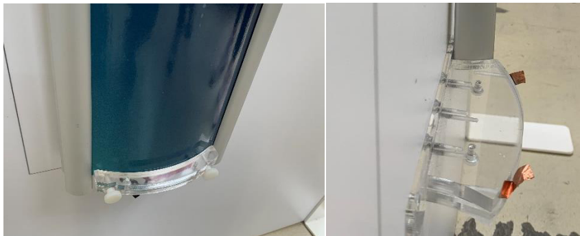
Abbildung 10: Anschlussstück aus PMMA mit Kupferbändern
