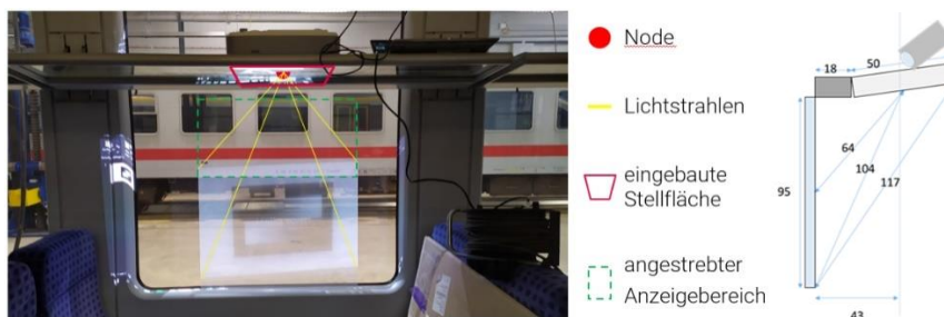
Bild 3: Konzeption des Zugdemonstrators mit zugehöriger Dimensionsabschätzung, Abmessungen in cm
