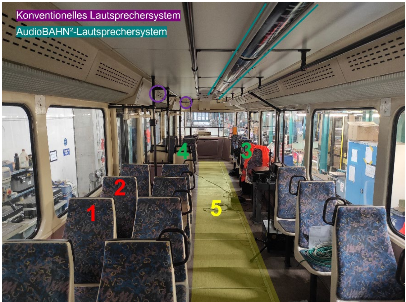
Abbildung 22: Einteilung der Tatra-T3DM in verschiedene Sitzbereiche (1, 2 bzw. rot = schlechte Bedingung; 3, 4 bzw. grün = gute Bedingung; gelb = Stehbereich)
