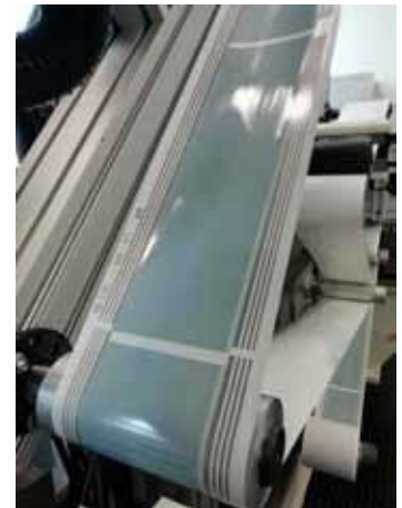
Abbildung 6: Rollendruck Dual-Layer Lautsprecherbahn
