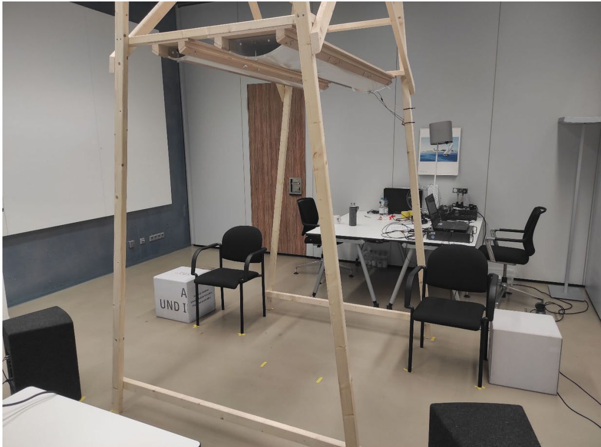
Abbildung 16: Einfacher Nachbau eines Zugabteils (Holzgestell mitsamt Halterungssystem)
