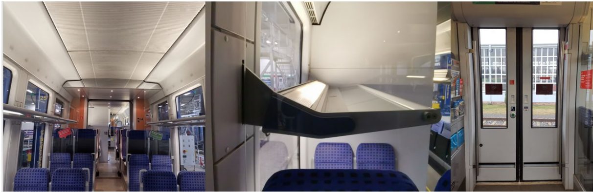
Abbildung 2: Integration in Deckenverkleidung (Loch-Wellblech) (links), in Gepäckablage als Lichtabdeckung (Transparenz) (Mitte), in Verkleidung/Türvouten (rechts)
