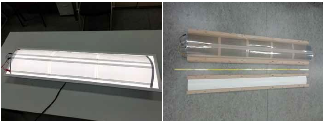
Abbildung 13: Labordemonstrator als semi-transparente Variante für ein Sound-Beleuchtungsmodul (links). Labordemonstratoren in einfacher und doppelter Breite mit papier- und folienbasierten Lautsprecherbahnen (rechts).
