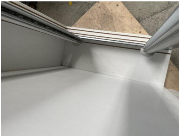
Abb. 5 – zweifaches Klemmprofil mit Führungsschiene für das Einspannen des Audioträgers, horizontal verstellbar mittels Schienenführung sowie vertikale Justiermöglichkeit
