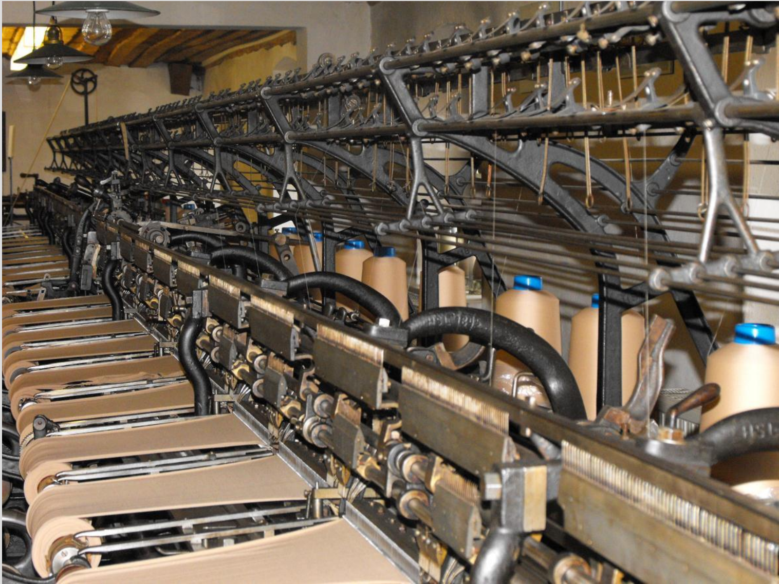
Cottonmaschine zur Herstellung von Strümpfen Standort Strumpfmuseum Gelenau
