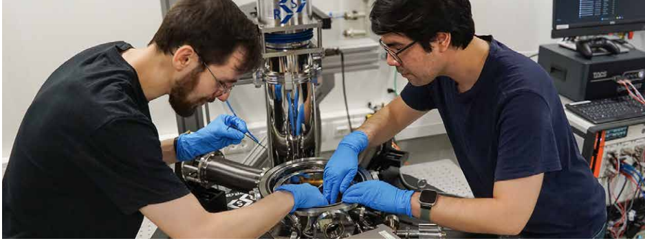
David Walther (l.) und Carlos Rincon, Wissenschaftliche Mitarbeiter der Professur Werkstoffe und Zuverlässigkeit mikrotechnischer Systeme der TU Chemnitz, installieren einen neuen Teststand in der Kammer eines Helium-Kryostaten. Er ermöglicht die Bestimmung thermischer Eigenschaften dünner Schichten bei Temperaturen zwischen -269 °C und +25 °C.
