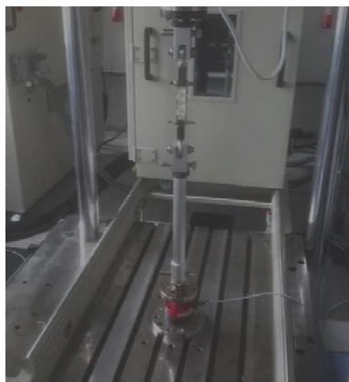
Abbildung 10: Prüfaufbau Langzeituntersuchung der Kettenstücke
