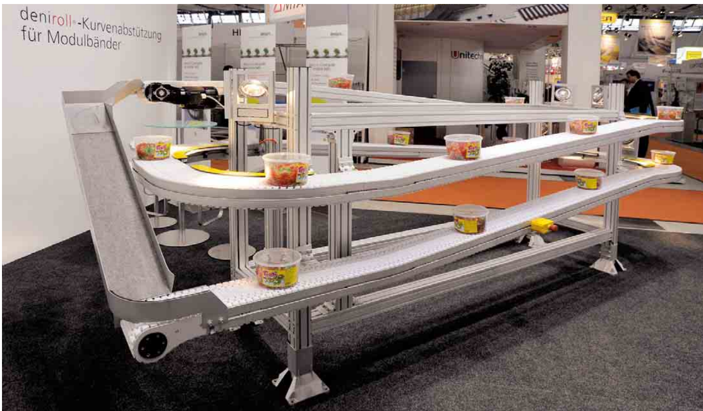
5 Mit sechs 90°-Kurven ausgeführter Wendelförderer
