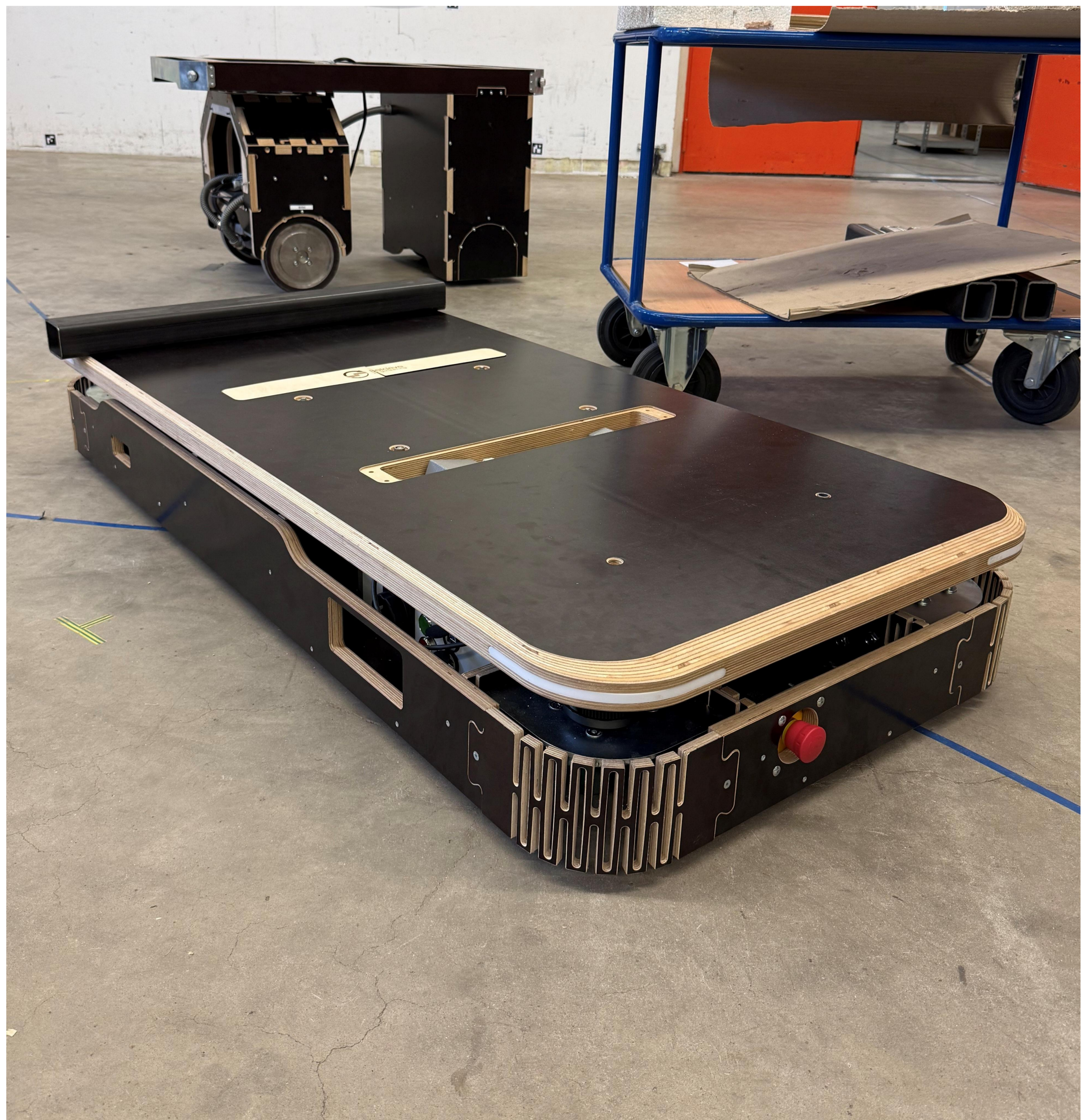
Abb. 1: Prototypen von fahrerlosen Transportfahrzeugen mit Tragstrukturen in Holzleichtbauweise
