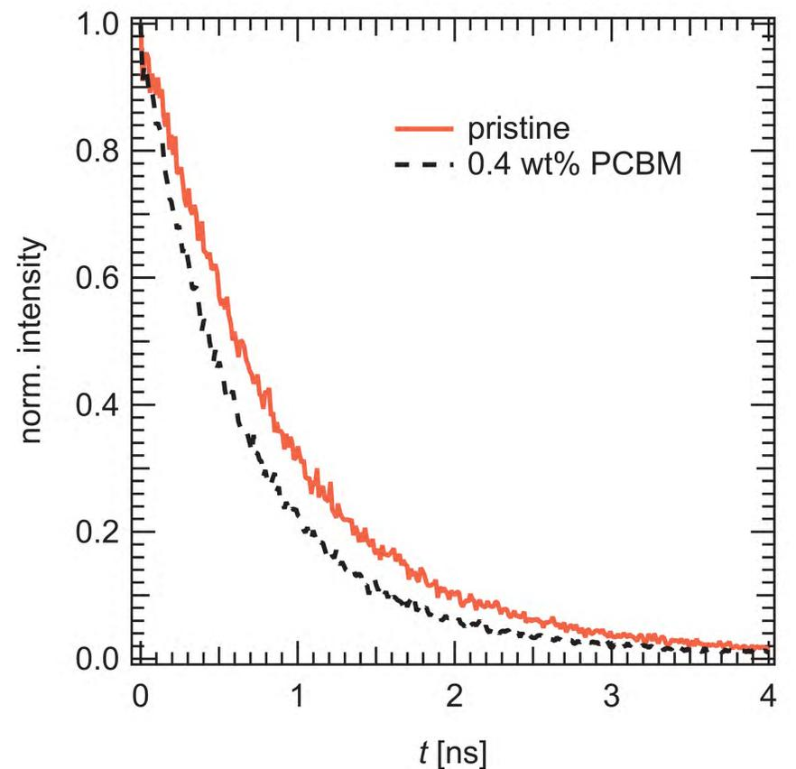
Die Abbildung zeigt den zeitlichen Zerfall der Photolumineszenz einer organischen Dünnschicht. Aufgrund des variierten Anteils an Fullerenen in der organischen Schicht verkürzt sich die Zerfallszeit. Mit Hilfe dieser Messungen der zeitaufgelösten Photolumineszenz kann die Exzitonendiffusionslänge in einem organischen Polymer bestimmt werden.
