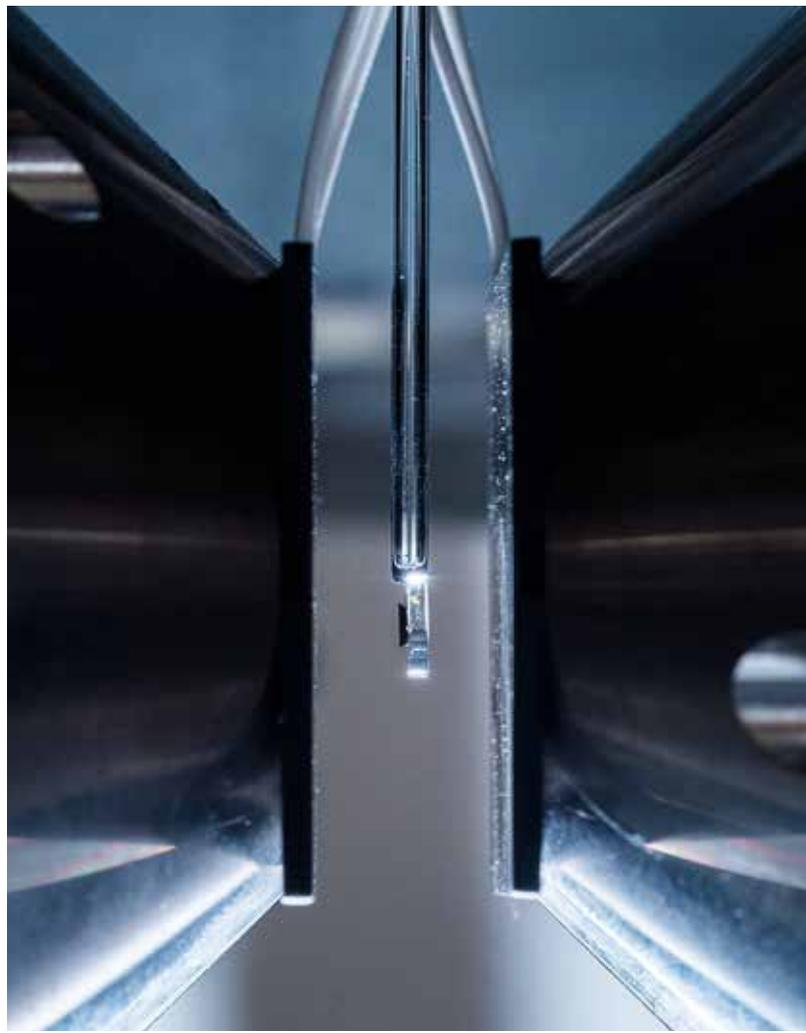
Am Magnetometer können die Forscher das magnetische Schaltverhalten der beschichteten Silizium-Waferstücke genau analysieren.
