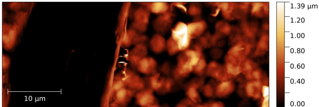
Abbildung 4.10: Das AFM-Bild der HDPE-Probe zeigt ein Höhenbild eines  $50\ \mu\text{m} \times 20\ \mu\text{m}$  großen Ausschnittes der Probe. Der schwarze Streifen stellt den Kratzer dar und die unregelmäßigen hellen Flecken die Probe.
