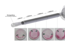
Abbildung: Beurteilung der Strangqualität auf Basis des Farbverdringtes
