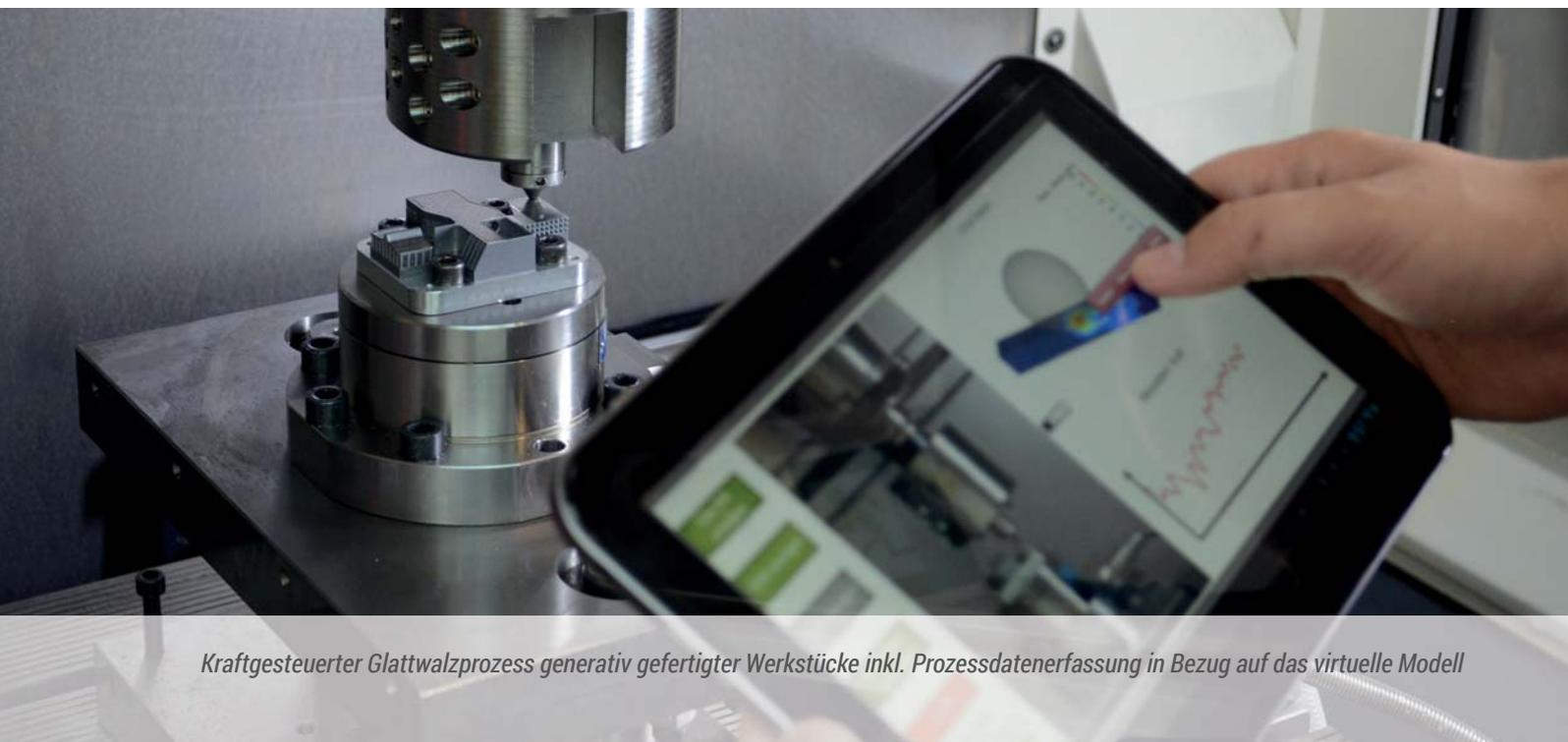
Kraftgesteuerter Glattwalzprozess generativ gefertigter Werkstücke inkl. Prozessdatenerfassung in Bezug auf das virtuelle Modell
