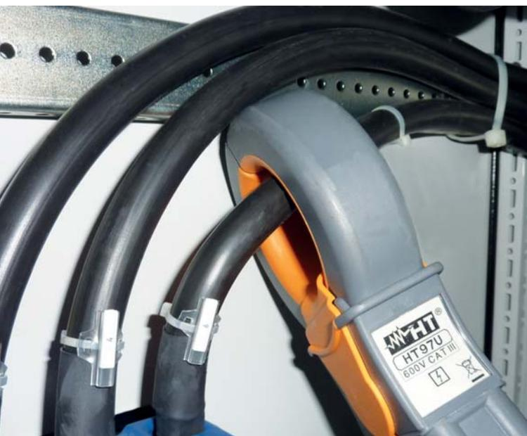
Mobile Energiemessung mit Strommesszange
