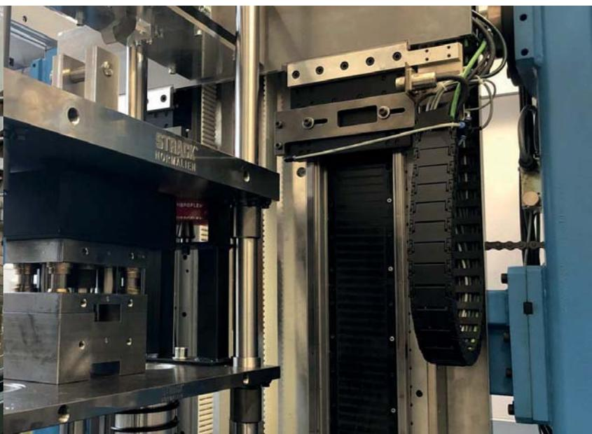
Linearmotor mit Schneidvorsatz
