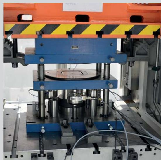
Versuchsaufbau zur Ermittlung der Einzelkräfte
