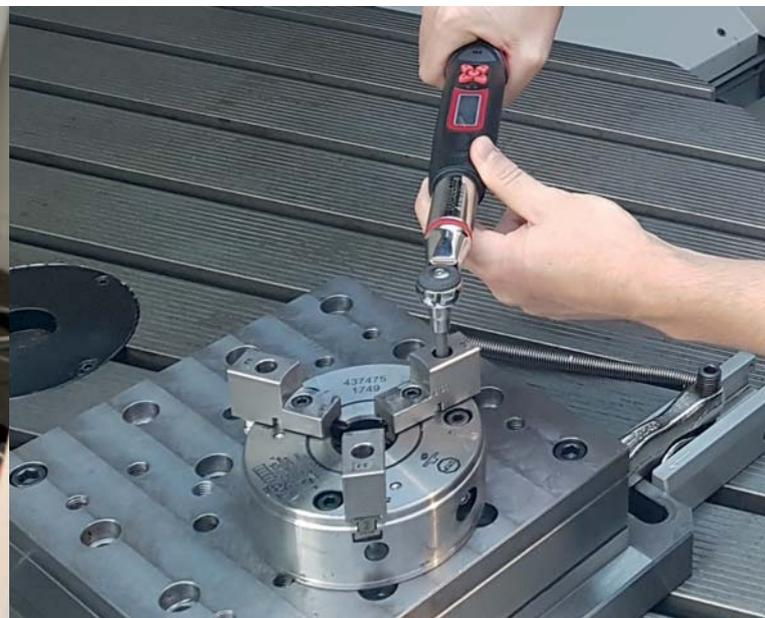
*Nutzertest zur Spannsicherheit rotatorischer Werkstücke*
