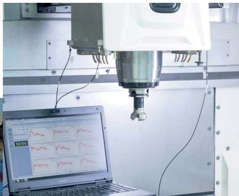
Charakterisierung des dynamischen Verhaltens von Maschinenstrukturen
