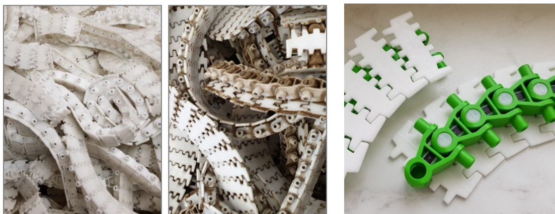
Abbildung 1: Gebrauchte Förderketten (links, Mitte) sowie neue Kette mit Grundkörper aus POM-Rezyklat (grün eingefärbt, rechts)
