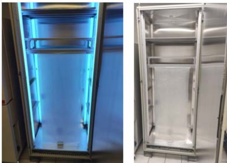
Abb. 2: Links: UV-Anlage offen und eingeschaltet Rechts: UV-Anlage offen und mit Folie bestückt
