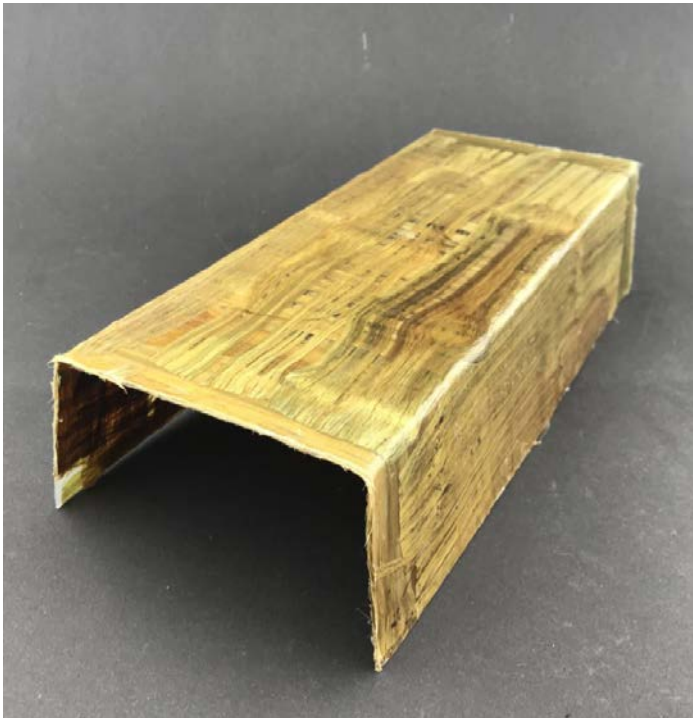
Abbildung 5: Umgeformtes Hanfbastsheet zu Halbschale
