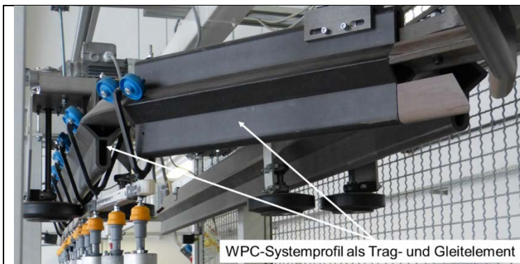
Bild 1: Hängefördersystem mit kombiniertem Trag- und Gleitprofil aus WPC
