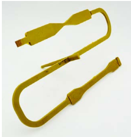
Bild 4: Im Spritzguss hergestelltes Bauteil aus gezielt beeinflusster Phenolharz-Formmasse
