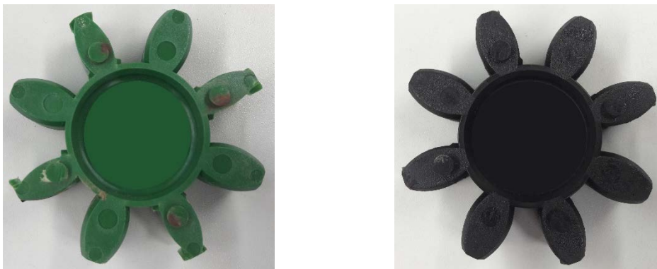
Abbildung 3: Vergleich eines marktüblichen Zahnkranzes (links) zum finalen Zahnkranzprototypen (rechts) in der Härtegrad-Kategorie 3 für die Kupplungsgröße 38 nach einem anwendungsnahen Kurzzeitversuch zur Beurteilung des Verschleißverhaltens in einem Verspannprüfstand
