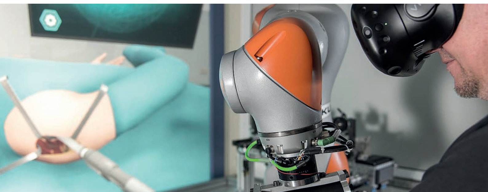
DynamicHIPS-Simulator: Haptisches Feedback mittels Roboterarm lässt Chirurgen Kräfte der OP-Schritte spüren
