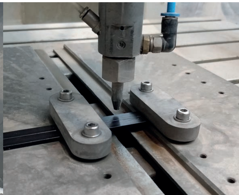
Trennen von Laufringen von Drahtwälzlagern mit Wasserabstrahlstrahlschneiden
