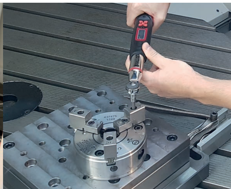
Nutzertest zur Spannsicherheit rotatorischer Werkstücke
