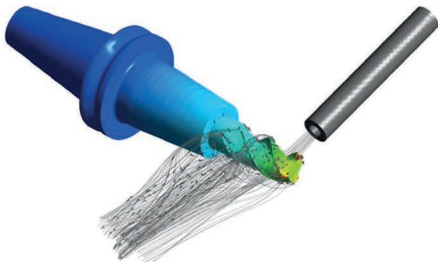
Numerische Simulation von Kühlströmung und Temperaturfeld im Fräswerkzeug
