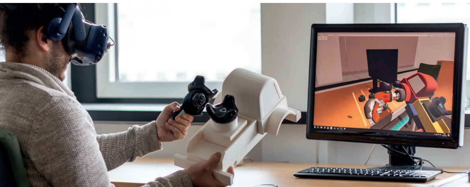
Entwicklung eines möglichst realen Montagetrainings durch die Kombination von Virtual Reality und realen, 3D-gedruckten Bauteilen
