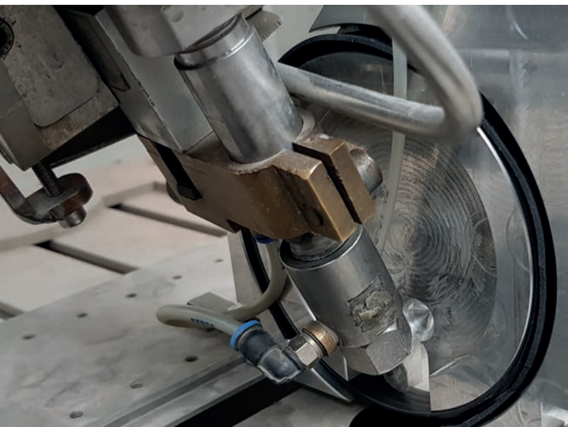
Trennen von Laufringen von Drahtwälzlagern mit Wasserabstrahlstrahlschneiden
