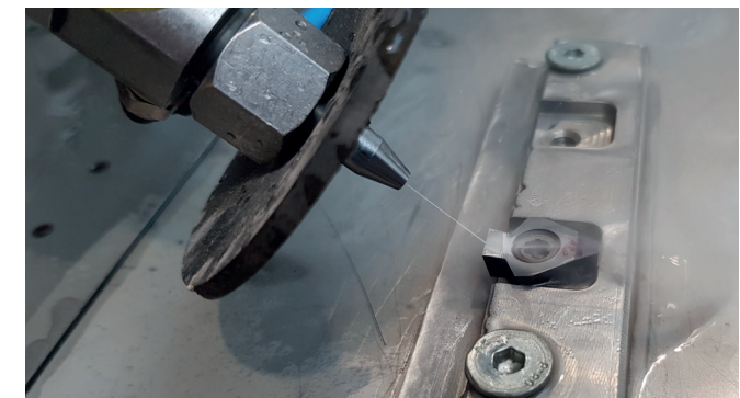
Schneidkantenpräparation mit Hochdruckwasserstrahl
