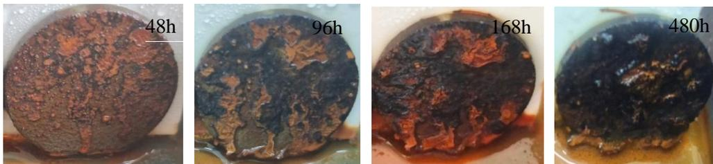
Abbildung 39: Bilder der plasmagespritzten  $(\text{Fe}_{0.9}\text{Co}_{0.1})_{76}\text{Mo}_4(\text{P}_{0.45}\text{C}_{0.2}\text{B}_{0.2}\text{Si}_{0.15})_{20}$  Beschichtungen im Salzsprühnebeltest nach unterschiedlichen Verweilzeiten.
