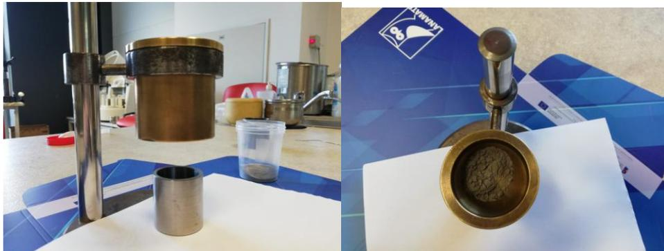
Abbildung 14: Ermittlung der Durchflussrate der Pulver mittels Hall flowmeter.
