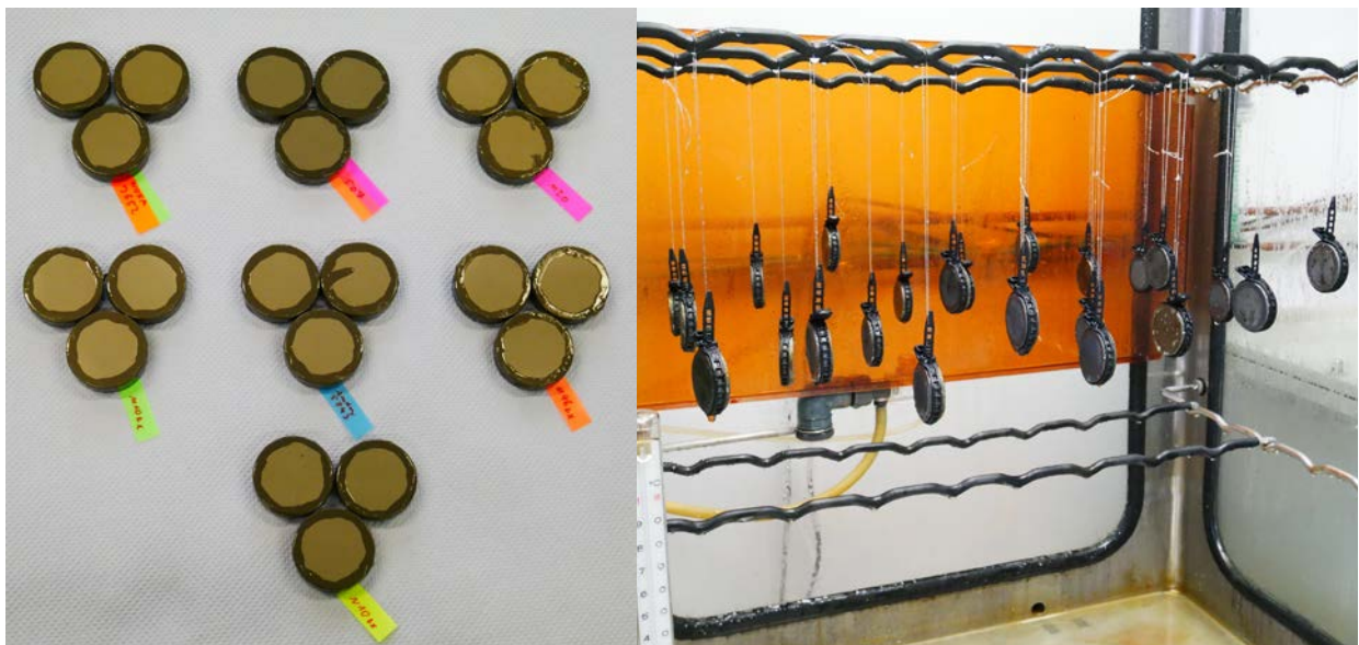
Abbildung 11: Links: mit Boots-lack versiegelte Proben für die Korrosionsuntersuchungen im Salzsprühnebeltest (rechter Bildausschnitt)
