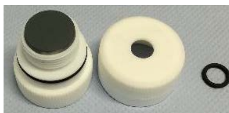
Abbildung 12: Probenhalter mit beschichtetem Substrat für die Langzeitauslagerung im flüssigen Medium.
