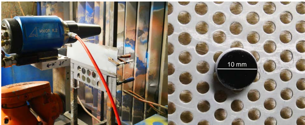
Abbildung 8: REM tauglicher, mit Klebepad präparierter Probenhalter zum Auffangen frei zirkulierender Partikel der Luftströmung innerhalb der Beschichtungs-kabine
