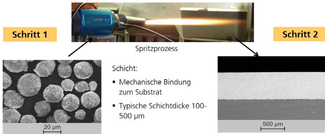
Abbildung 1: Prozessschritte (Pulver und Verarbeitung) bei der Herstellung thermisch gespritzter Schichten durch HVOF [6].
