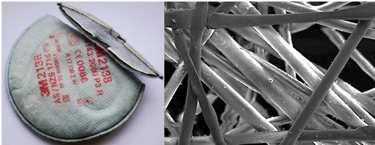
Abbildung 9: Atemschutzfilter (3M 2138 / AS / NZS 1716 P3) zur Analyse der Partikelkontamination bzw. Belastung des Versuchspersonals
