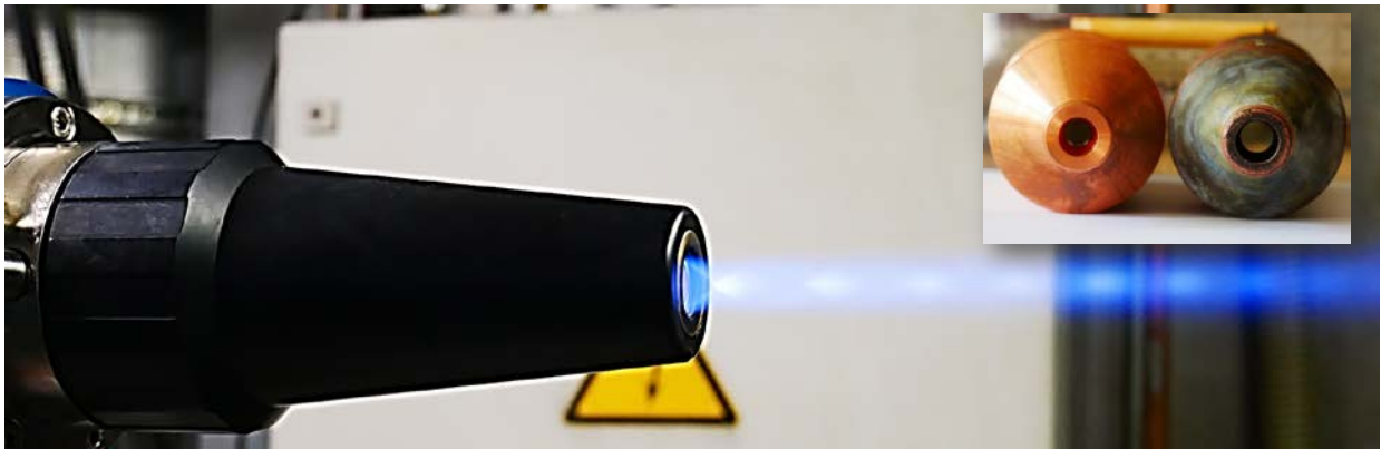
Abbildung 4: K2 Brennersystem der Firma GTV. Oben rechts sind die die beiden Brennkammertypen zu sehen, die sich im Wesentlichen durch Ihren Austrittsquerschnitt voneinander unterscheiden
