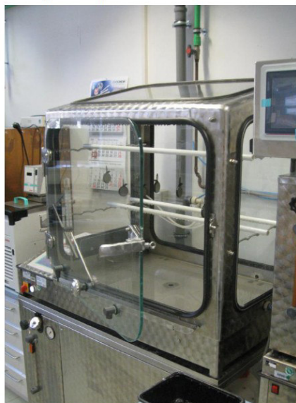
Abbildung 38: Klimakammer für den Salzsprühnebeltest nach DIN EN ISO 9227; Innen hydrophobierte Proben mit NiAl 95/5 Beschichtung und JB9-2K-LT Versiegelung (rechts)
