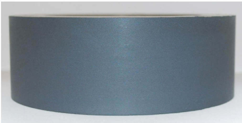
Abbildung 50: Lagerring mit Grundsicht NiAl 95/5 und Versieglung (JB9 2K-LT); mechanische Aktivierung (Trockeneisstrahlen); Deckschicht \text{Al}_2\text{O}_3/\text{TiO}_2 70/30 (DELTA Fa. GTV); geschliffen
