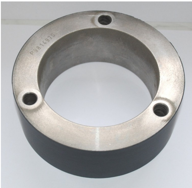
Abbildung 49: Lagerring mit Grundsicht NiAl 95/5 und Versiegelung (JB9 2K-LT); mechanische Aktivierung (Trockeneisstrahlen); Deckschicht Al_2O_3/TiO_2 70/30 (DELTA Fa. GTV)
