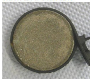
Abbildung 38: Klimakammer für den Salzsprühnebeltest nach DIN EN ISO 9227; Innen hydrophobierte Proben mit NiAl 95/5 Beschichtung und JB9-2K-LT Versiegelung (rechts)
