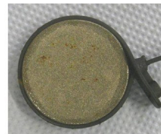
Abbildung 38: Klimakammer für den Salzsprühnebeltest nach DIN EN ISO 9227; Innen hydrophobierte Proben mit NiAl 95/5 Beschichtung und JB9-2K-LT Versiegelung (rechts)
