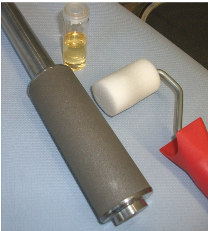
Abbildung 47: Hydraulikzylinder mit Grundsicht NiAl 95/5 und Versiegelung (JB9 2K-LT)
