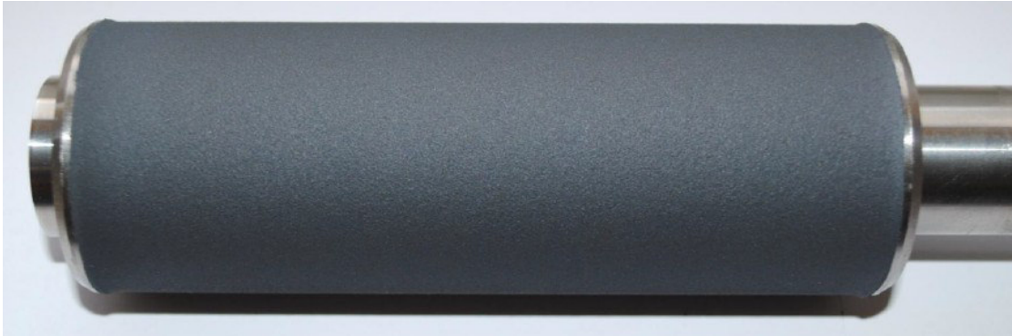
Abbildung 48: Hydraulikzylinder mit Grundsicht NiAl 95/5 und Versiegelung (JB9 2K-LT); mechanische Aktivierung (Trockeneisstrahlen); Deckschicht Al_2O_3/TiO_2 70/30 (F6 Fa. GTV)
