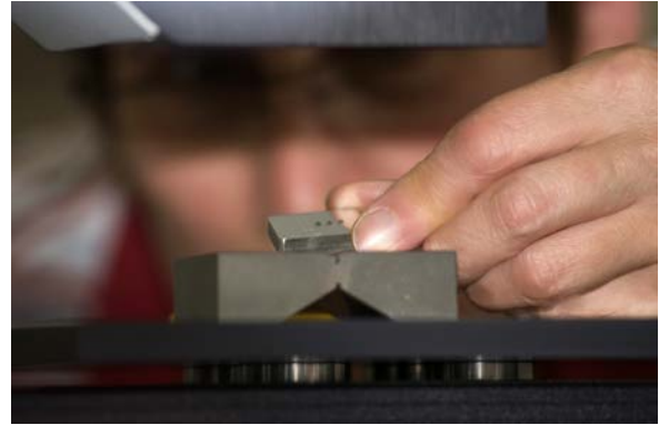
Ermittlung des Reibkoeffizienten und Verschleißprüfung an einem beschichteten Stahl
