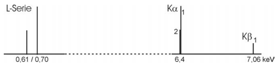
Abb.4 Resultierende Röntgenlinien für das Element Eisen mit typischer Energielage und Intensitätsverhältnissen
