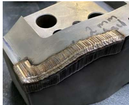
Werkzeugreparatur durch manuelles Laserauftragschweißen
