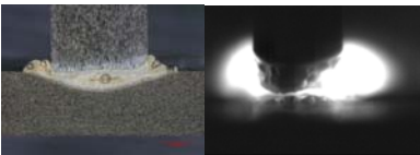
Schweißdraht aus Fe85Cr4Mo8V2C1
