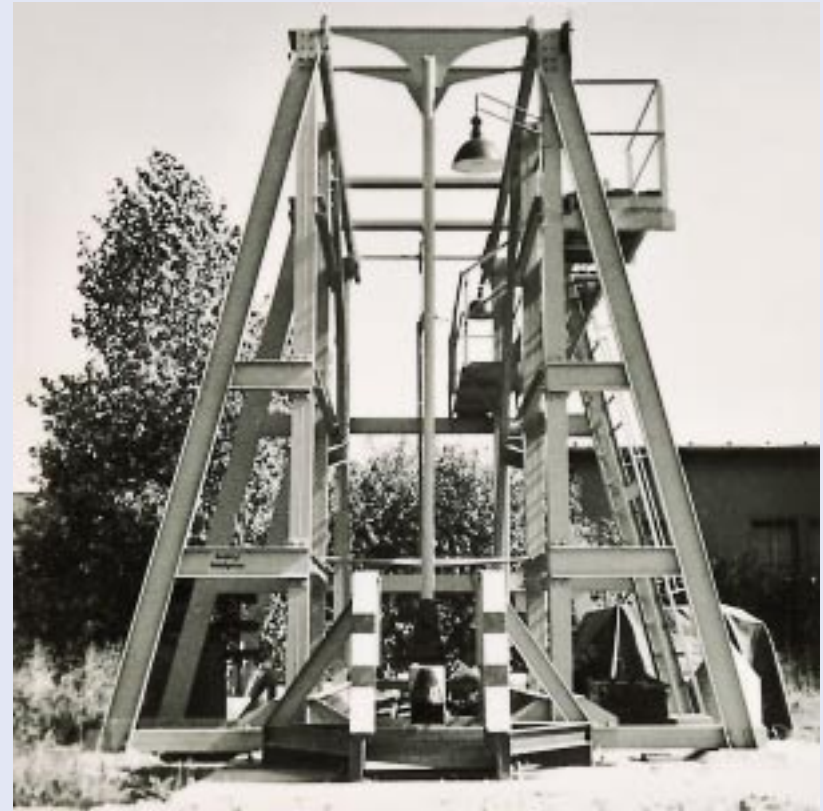
Deutschlands größtes Pendelschlagwerk zur Untersuchung des Sprödbruchverhaltens von Schweißverbindungen
