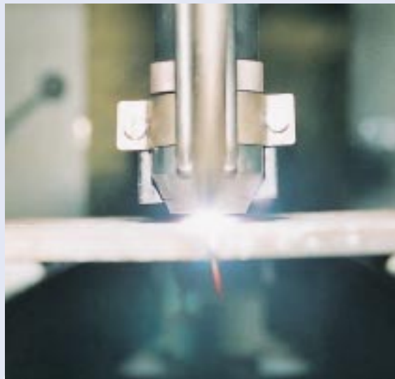
Plasmaschweißen von Duplexstahl
