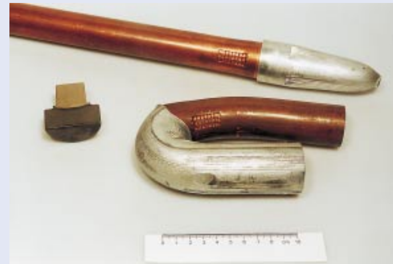
Reibgeschweißte Al-Cu-Verbindung nach dem Biegeversuch
