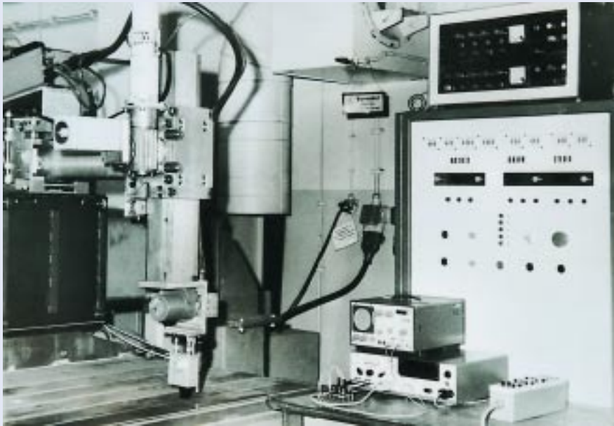
Schweißroboter mit integriertem Reflexionssensor
