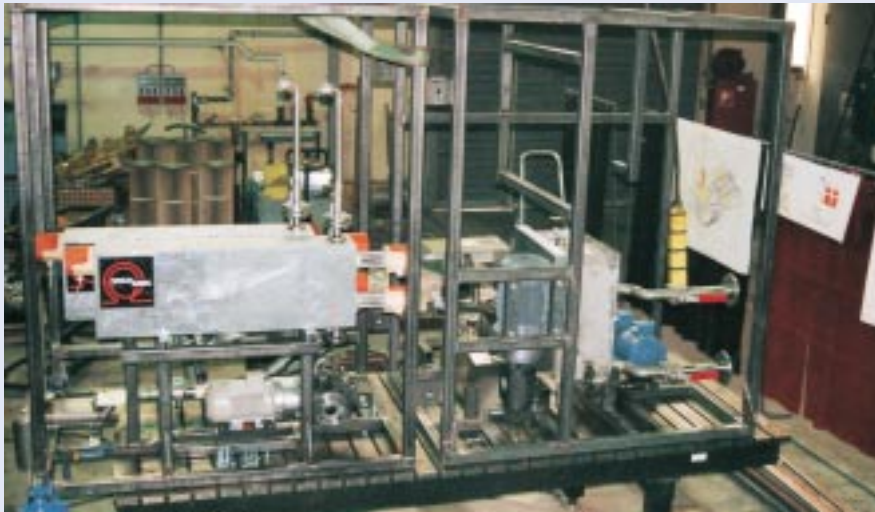
Schweißfertigung eines Hydraulikprüfstandes
