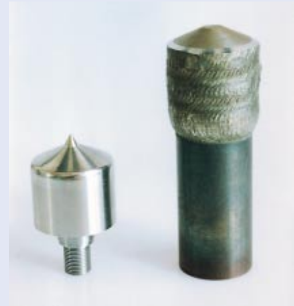
Formgebend auftraggeschweißter Stempel für das Bohrungsdrücken
