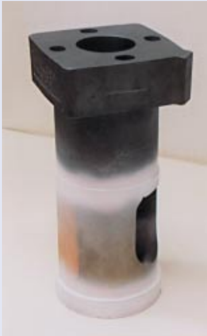
Gelöteter Ventilkorb für Großdieselmotoren
