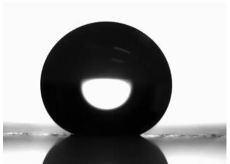
Flüssigkeitstropfen auf einer wasserabweisenden Oberfläche
