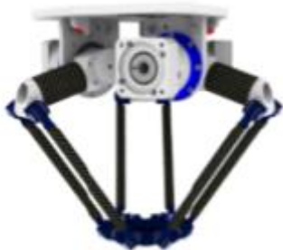
Konstruktion auf der Grundlage des DELTA Roboters
