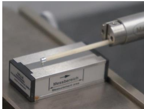
Abbildung links: Tastschnittgerät, rechts: Messung mit Tastschnittgerät auf einem Normal
