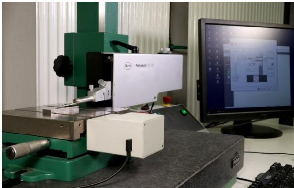
Abbildung links: Tastschnittgerät, rechts: Messung mit Tastschnittgerät auf einem Normal
