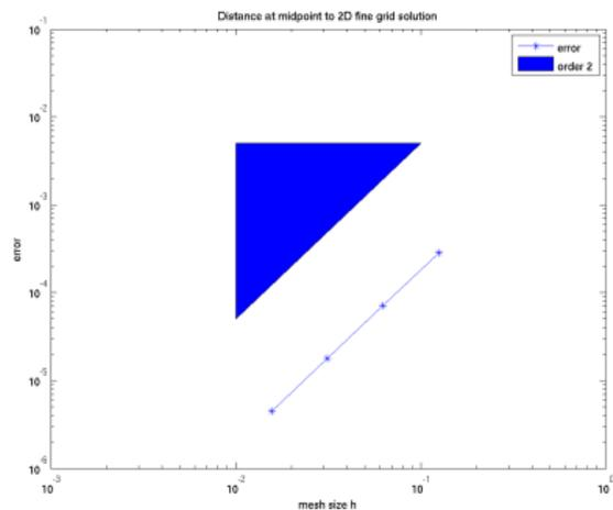
Abbildung 4: Fehler zur Feingitterlösung am Mittelpunkt des Einheitsquadrates für obige Approximationen 1. Ordnung (links) bzw. 2. Ordnung (rechts) der Robin-Randbedingungen.
