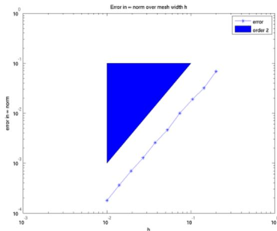
**Abbildung 2:** Fehler in der diskreten  $L^\infty$ -Norm bei konstanter (links) bzw. linearer Randwertextrapolation (rechts) am Beispiel  $-\Delta u = 4$  auf dem Einheitskreis,  $u = 0$  am Rand; exakte Lösung:  $u = 1 - (x_1^2 + x_2^2)$ .
