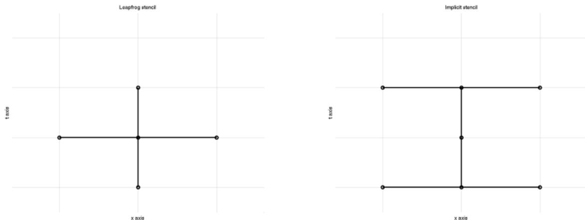
Abbildung 6: Schematische Differenzensterne für das (explizite) Leapfrog-Verfahren (links) und ein implizites Schema (rechts).
