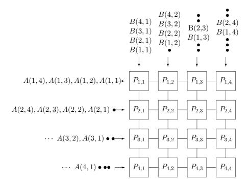
Prozessor  $P_{i,j}$  hat die Variable C(i,j) in seinem Speicher, die am Anfang auf 0 gesetzt ist und führt folgende Operationen aus: Er empfängt A(i,l) von links und B(l,j) von oben, berechnet  $C(i,j) := C(i,j) + A(i,l) \cdot B(l,j)$  und schickt A(i,l) nach  $P_{i,j+1}$  (also nach rechts), falls  $j+1 \le 4$ , B(l,j) nach  $P_{i+1,j}$  (also nach unten), falls  $i+1 \le 4$ .
