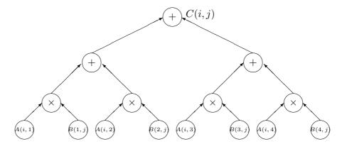
Um das Produkt  $C = A \times B$  zu berechnen, brauchen wir einen solchen dag für jedes C(i,j). Mit n Prozessoren kann jeder einzelne dag in Zeit  $O(\log n)$  ausgewertet werden. Mit  $n^3$  Prozessoren können wir alle dag's parallel und damit das Produkt in  $O(\log n)$  Zeit berechnen.
