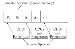
Wir beachten schon jetzt, daß die Anzahl der CPU's einer PRAM unbegrenzt groß werden kann (was für die theoretische Behandlung günstiger ist). Im Gegensatz zur RAM ist die PRAM kein unbestritten geeignetes Modell paralleler Computer. Der simultane Zugriff mehrerer CPU's auf einen Speicher
