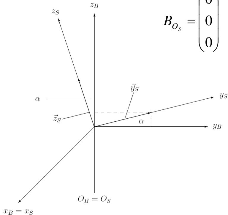
$$B_{O_S} = \begin{pmatrix} 0 \\ 0 \\ 0 \end{pmatrix} \quad B_{\vec{x}_S} = \begin{pmatrix} \vec{x}_B \cdot \vec{x}_S \\ \vec{y}_B \cdot \vec{x}_S \\ \vec{z}_B \cdot \vec{x}_S \end{pmatrix} = \begin{pmatrix} 1 \\ 0 \\ 0 \end{pmatrix}$$
