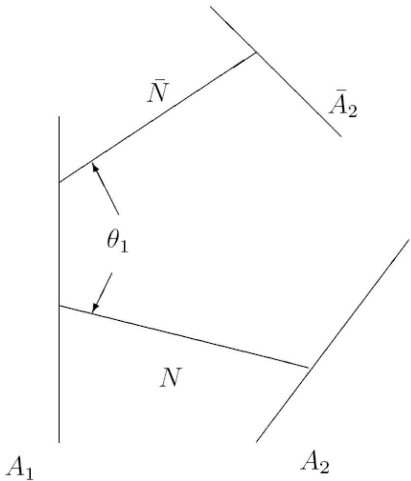
A<sub>2</sub> und der gesamte restliche Roboterarm dreht sich um die Achse A<sub>1</sub> (Rotationsgelenk)
