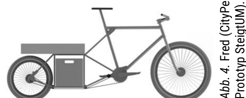
Fred (SteigtUM Prototyp) 2 Räder, Last hinten, keine Tretunterstützung
