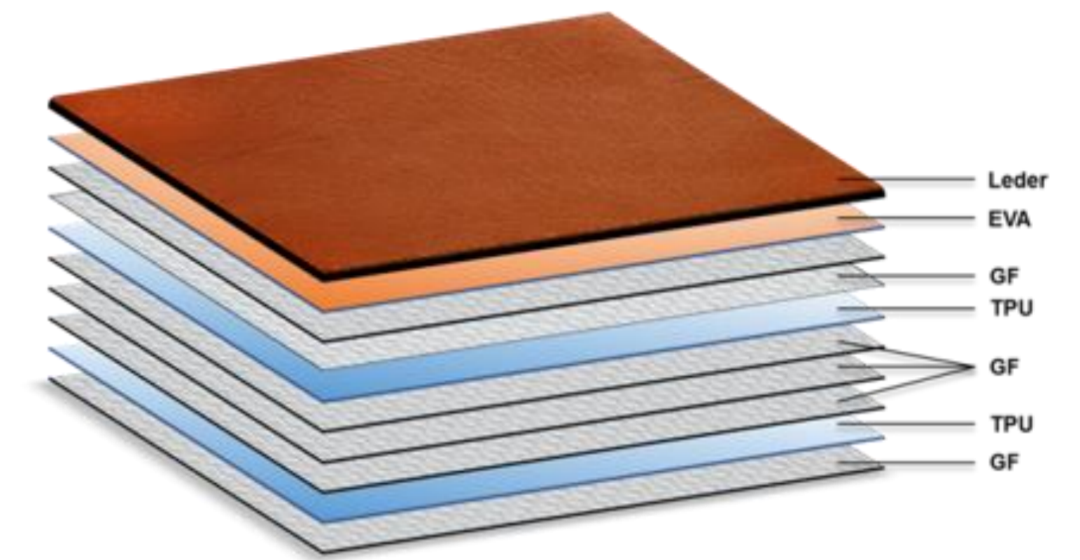
Abb. 1: hybrides Laminat aus glasfaserverstärktem TPU, EVA und Leder
