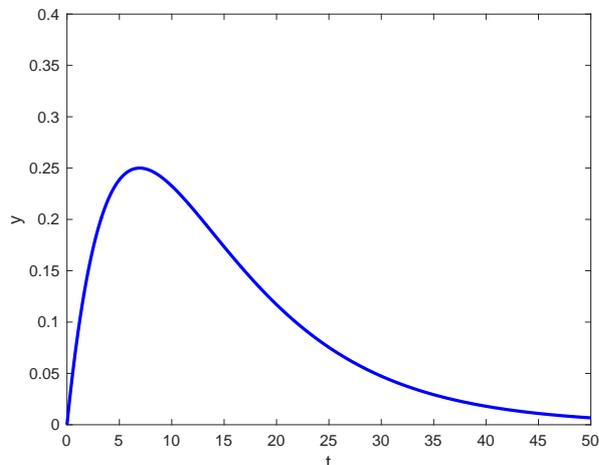
Abbau einer organischen Substanz in zwei Stufen:  $\alpha = 0.1, \beta = 0.2, x_0 = 1.0, y_0 = 0.0$
