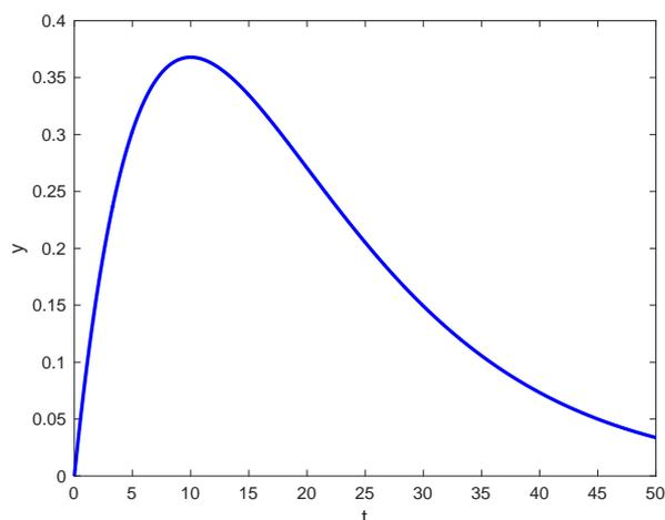
Abbau einer organischen Substanz in zwei Stufen:  $\alpha = \beta = 0.1, x_0 = 1.0, y_0 = 0.0$
