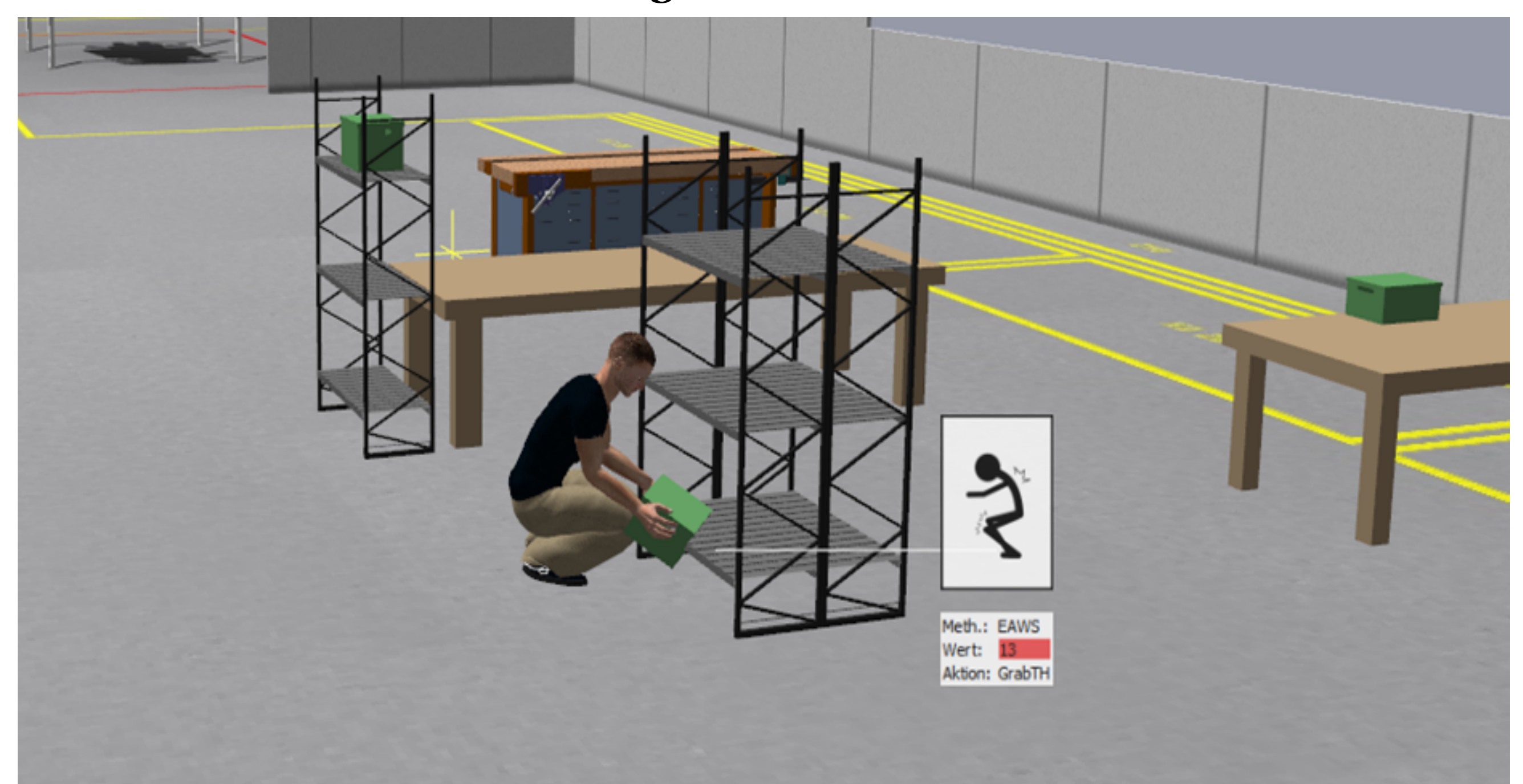
Abbildung 2: Unterstützung der Videoanalyse durch Markierung der Problemstelle mittels eines Piktogramms, welches die ungünstige Pose darstellt. Weitere zur Verfügung gestellte Informationen sind die Angabe der Bewertungsmethode (die das Problem identifiziert hat) sowie deren Gesamtpunktzahl und die Aktion die während der Bewertung durchgeführt wurde.
