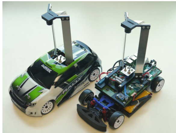
Abbildung 1.1: Ansicht des TUCar mit und ohne Hülle.
