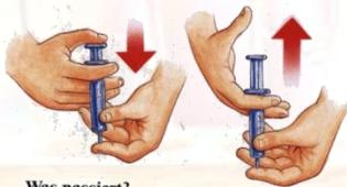
Luft sich komprimieren kann; der Kolben zwingt sie, weniger Raum einzunehmen. Die Komprimierung erhöht den Luftdruck, d. h. die Kraft, die gegen die Wände der Spitze und den Finger drückt. Der Kolben kehrt in die Ausgangsposition zurück, weil komprimierte Luft dazu neigt, sich auszudehnen: der Druck verringert sich nun, und es entsteht ein Unterdruck.
