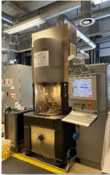
Abb.: Bearbeitemaschine zur präzisen elektrochemischen Metallbearbeitung (links); Bearbeitungsergebnis (Mitte) und Strömungsstrukturen im Detail (rechts)
