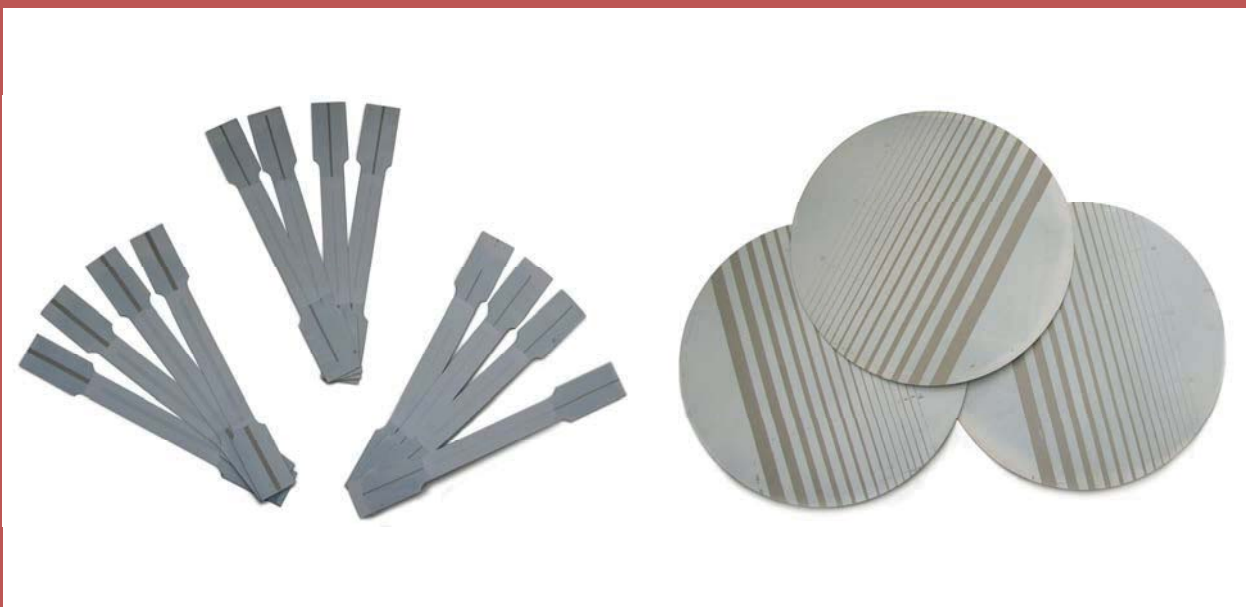
Lackierte und bedruckte Probekörper als Zugstäbe und Ronden für Umformversuche
