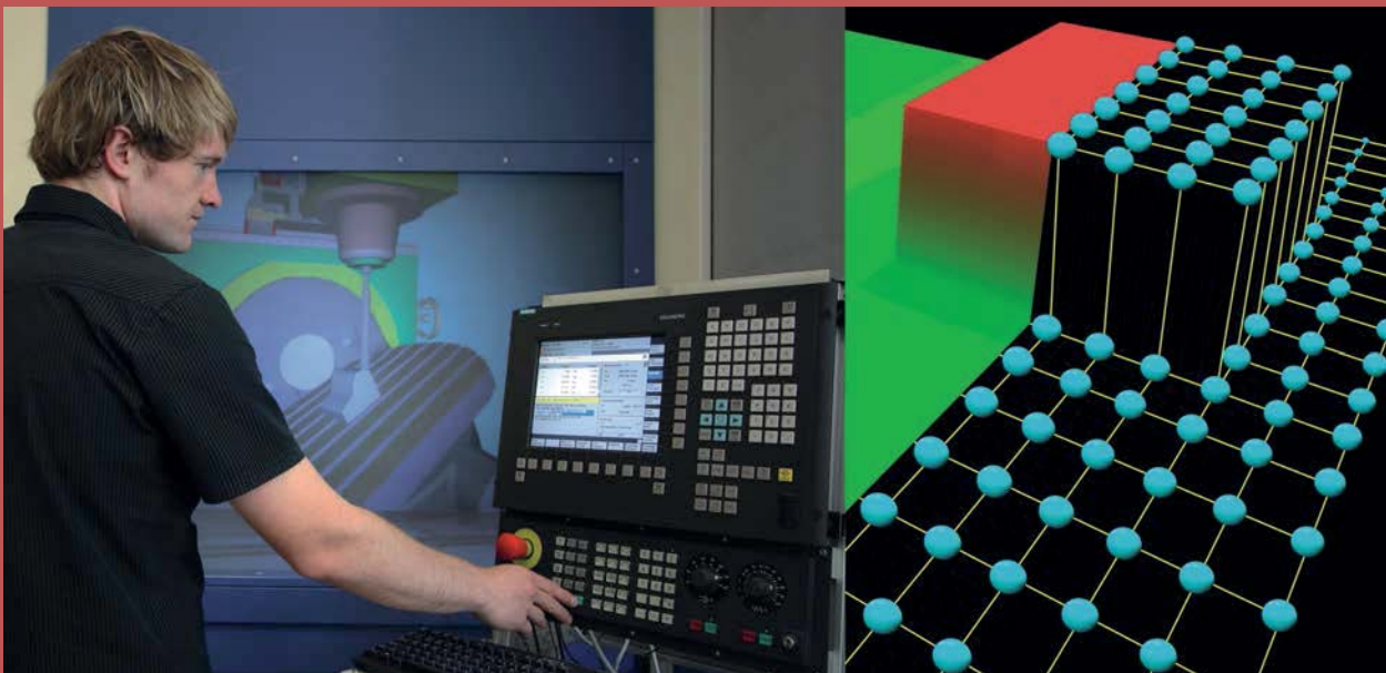
Hardware-in-the-Loop-Kopplung reale NC-Steuerung und VR-Maschinenmodell / Nagelbrettmodell zur Abtragssimulation
