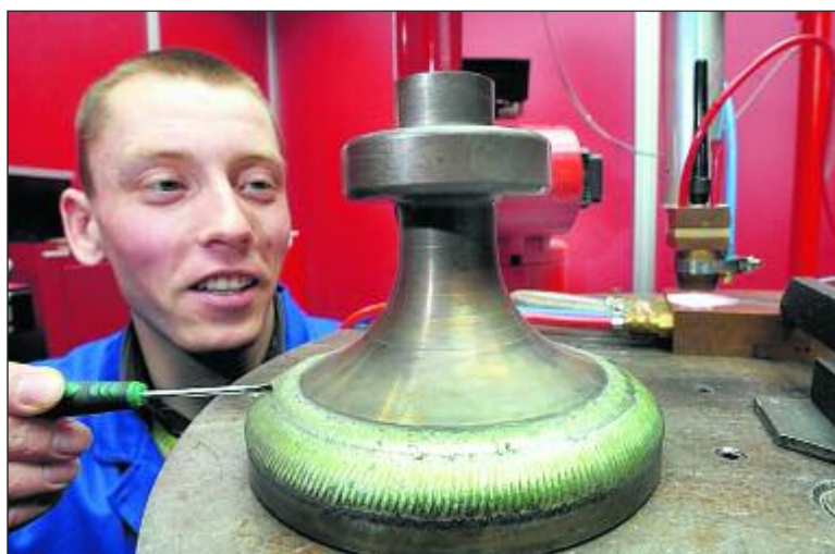
Lars Ebert mit dem Ventil eines Schiffsdieselmotors. Der 27-Jährige forscht an speziellen Metall-Legierungen, die das Material an besonders beanspruchten Stellen noch härter machen sollen.
