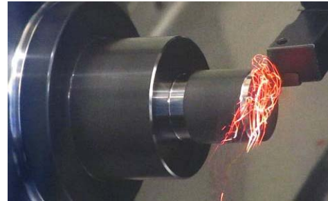
Hartdrehen einer Versuchsprobe aus 42CrMo4 mit 58 HRC
