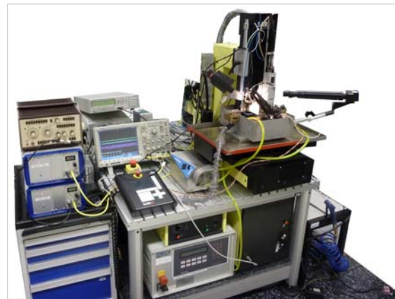
Mikro-EDM-Versuchsstand des Fraunhofer IWU: mit modernster Messtechnik wird die Bearbeitbarkeit neuer Materialien untersucht
