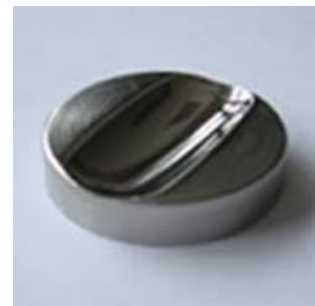
Abb.: Tablettenstempel mit PECM hergestellt
