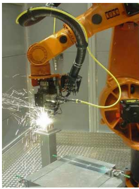
Abbildung 13: Standard-6-Achsen-Knickarmroboter mit Laserschweißeinheit
