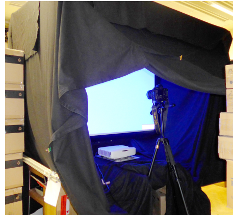
Abbildung 71: Aufbau des verwendeten Teststandes zur photometrischen Kalibrierung von Aufnahmegegeräten
