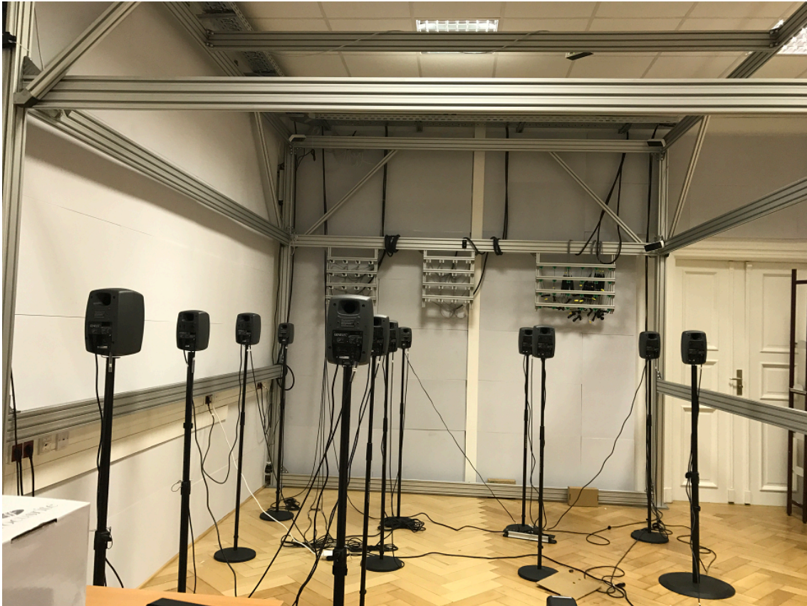
Abbildung 4: Positionen der Mikrofonarrays und Lautsprecher im audiovisuellen Labor.
