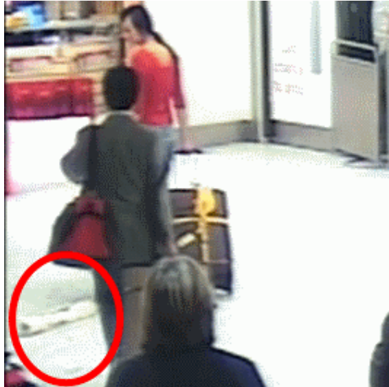
Abbildung 13: Das in dieser Videoszene unmittelbar vorher verlorene Papierbündel (roter Kreis) ist für Menschen relativ gut erkennbar. Automatisierte Trennungsvorgänge können aufgrund der Ähnlichkeit zum Untergrund allerdings nur sehr schlecht zwischen beidem unterscheiden.
