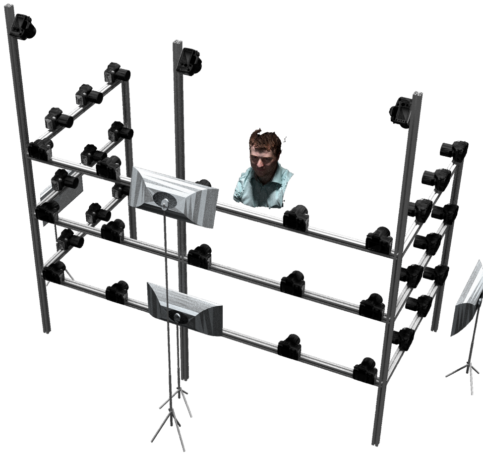
Abbildung 36: Aufbau des aus 36 Kameras bestehenden Body Scanners zur 3D-Modellerstellung des Oberkörpers.
