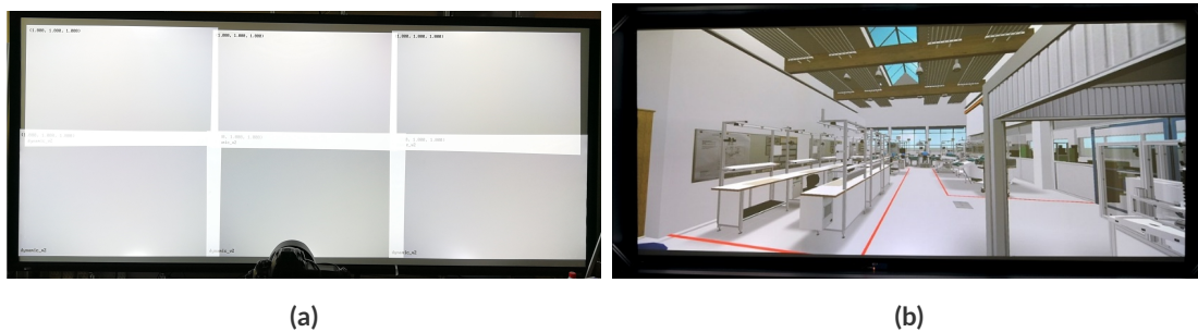
Abbildung 69: Ausgangssituation nach dem ersten Einschalten eines Multiprojektorsystems (a). Nach erfolgreicher Kalibrierung wirkt die Projektionsfläche wie ein einheitliches Bild (b).
